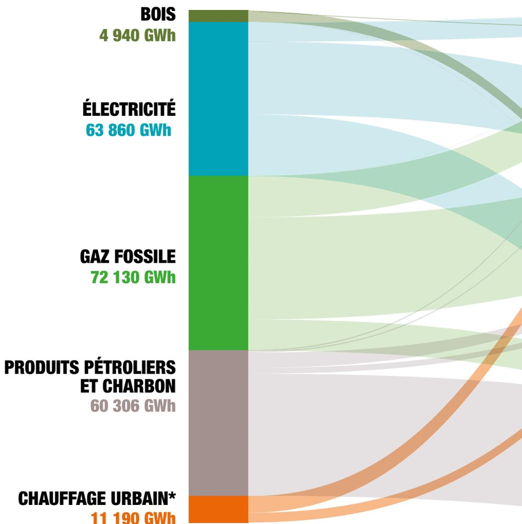
\*Chauffage urbain : réseau permettant la distribution de chaleur produite par une ou plusieurs chaufferies à plusieurs utilis
