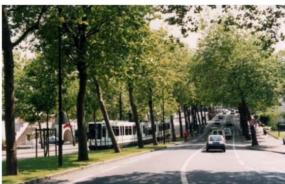
Le boulevard du Petit Port comprenait deux chaussées de trois voies de circulation chacune avant l'installation du tramway. La ligne 2 emprunte dorénavant l'équivalent d'une chaussée de trois voies. Sur l'autre chaussée, une route à double sens de deux voies et des pistes cyclables ont été aménagées. En termes de circulation, 50 000 véhicules et 80 000 personnes
