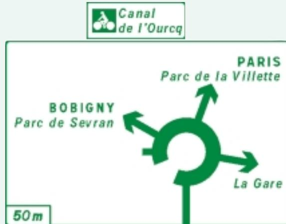
**Panneau Dv43a.** Panneau de présignalisation courante des carrefours comportant une indication de destination et une indication de distance.
