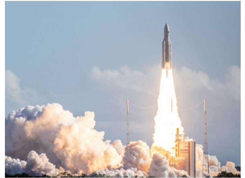
Association d'hydrogène liquide (28T) et d'oxygène liquide (162T) pour lancer la fusée Ariane 5
