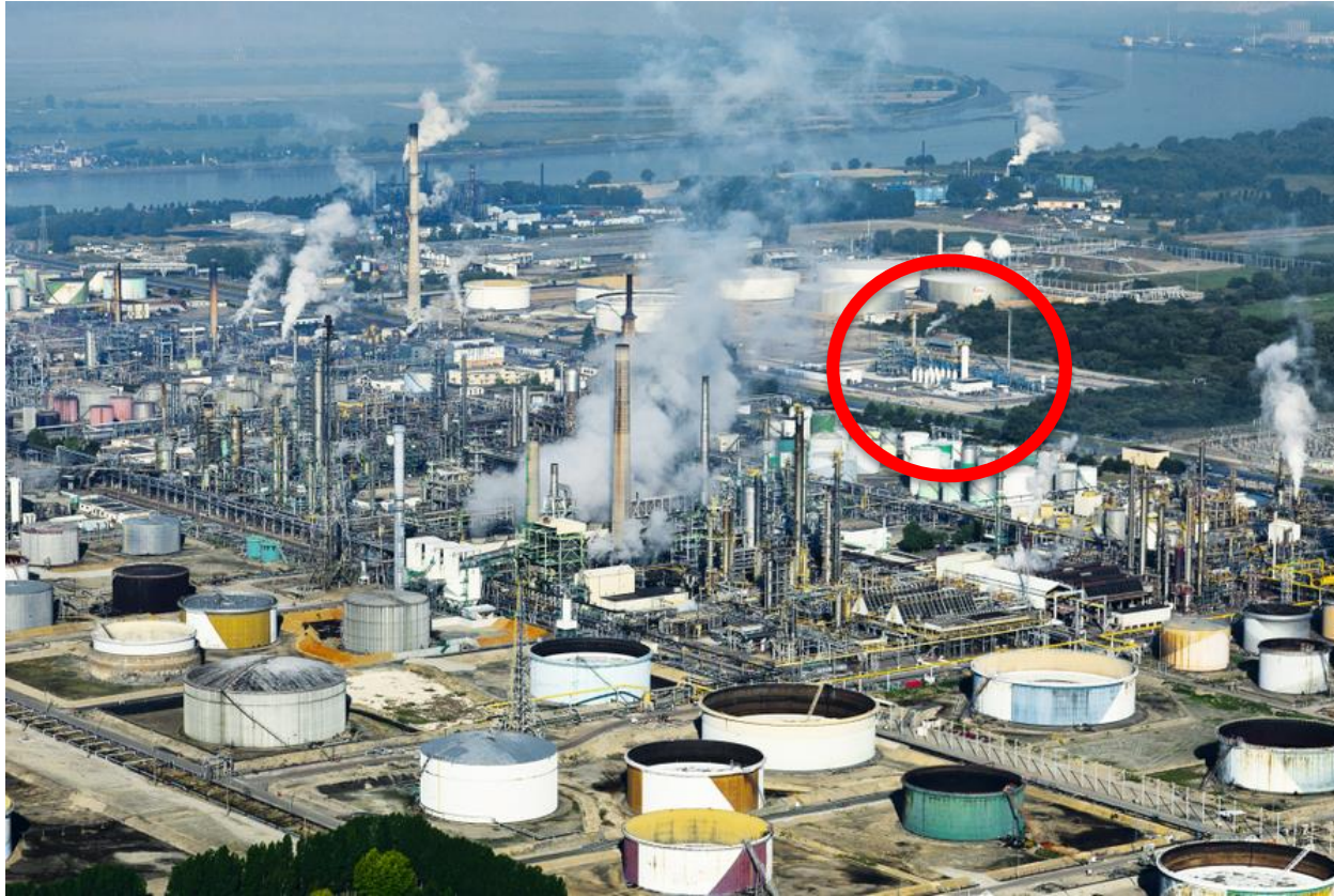
Plateforme industrielle (énergies, chimie) de Port-Jérôme sur Seine Au premier plan, dépôt pétrolier et raffinerie d'ExxonMobil Au second plan à droite, unité SMR d'Air Liquide (avec installation CCUS Cryocap™ – 100 000 T CO 2 / an)
