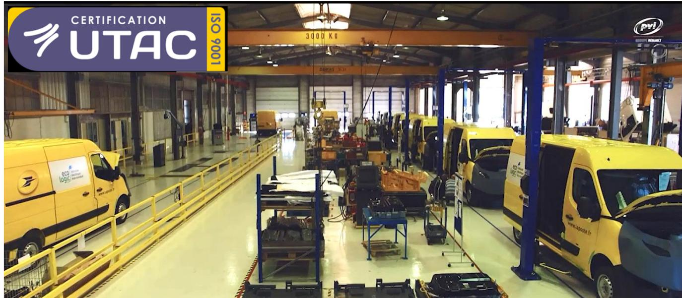
Une ligne VUL d'une **capacité de production de 3000 unités par an**, elle est équipée des mêmes outils de levage, vissage et de contrôle que l'usine de renault à Batilly.
