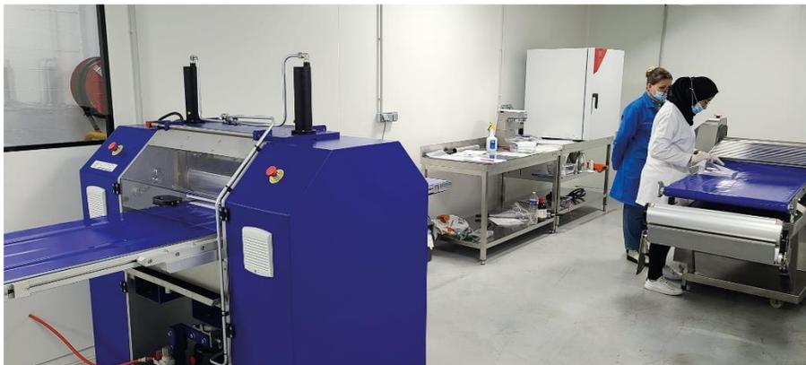
R&D et ligne de fabrication de membranes AEM pour électrolyse AEM (membrane échangeuse d'anions) à Orly (94)
