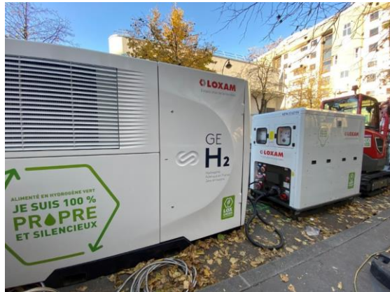
Expérimentation du groupe électrogène GEH2 pour un chantier CPCU et Ville de Paris
