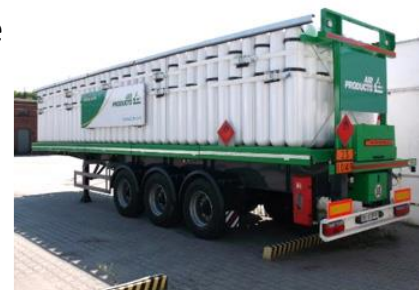
Remarque d'hydrogène comprimé © Air Products
