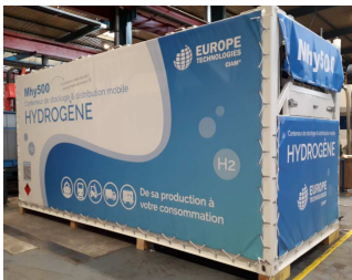
Chargement de l'H2 par swapping de containers (450 kg/container)
