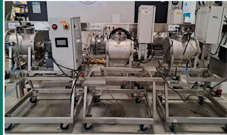
Figure 2 : Photo d'un réacteur pilote anaérobie, (1) Moteur d'agitation, (2) Réacteur double enveloppe, (3) Sas d'alimentation/soufflage, (4) Système de contrôle et d'acquisition des données en ligne
