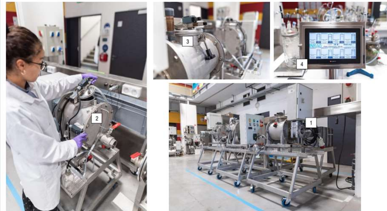
Figure 2 : Photo d'un réacteur pilote anaérobie, (1) Moteur d'agitation, (2) Réacteur double enveloppe, (3) Sas d'alimentation/soufflage, (4) Système de contrôle et d'acquisition des données en ligne
