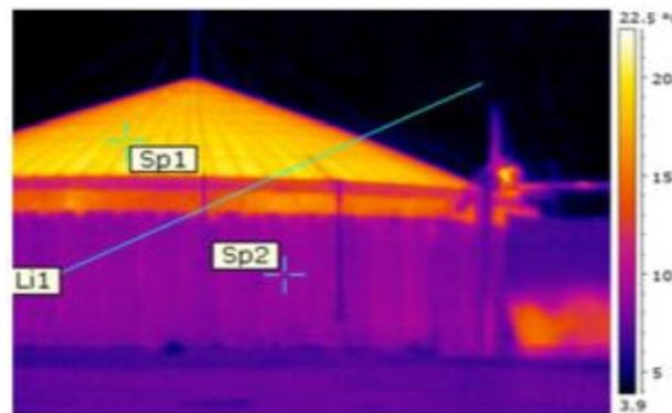
Déperditions thermiques sur un digesteur voie liquide
