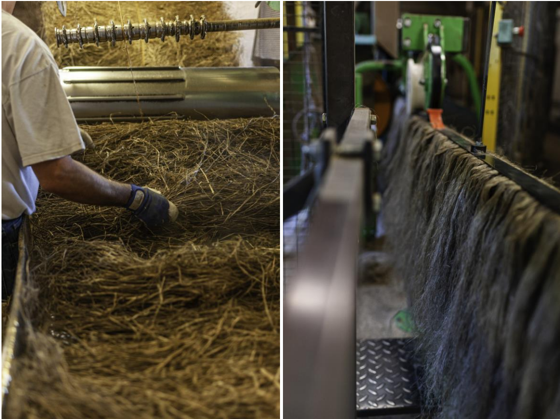
Ligne de teillage du lin des Etablissements Devogèle à Chailly-en-Brie (77) – Filasse de lin sortant de la teilleuse (Semae-Joao de Moura/ Entreprise Devogèle)
