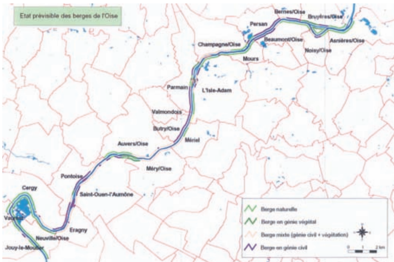
Etat prévisible des berges à 10 ans Source : CG95
