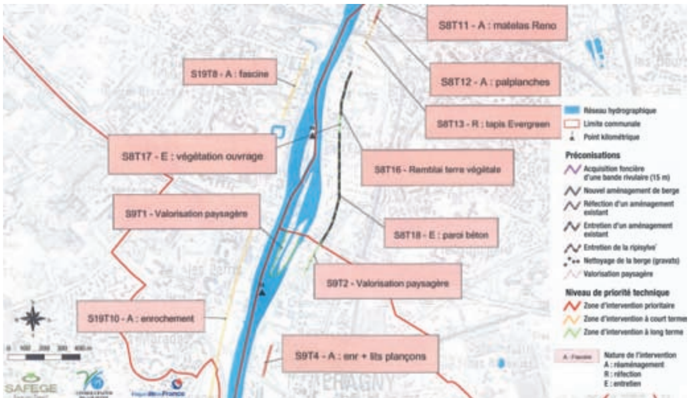
Exemple de préconisations d'aménagements par tronçons Source : Extrait de l'étude d'aménagement des berges - CG95
